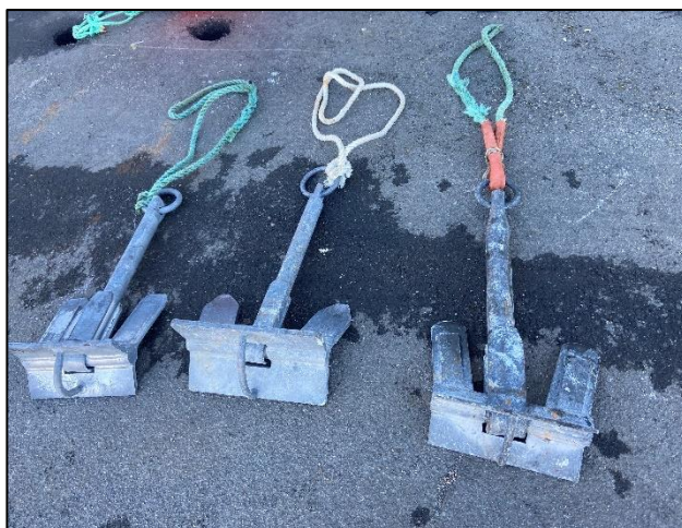
Figur 9: Tre av jernene brukt på de tre garnlenkene. Foto: SHK
