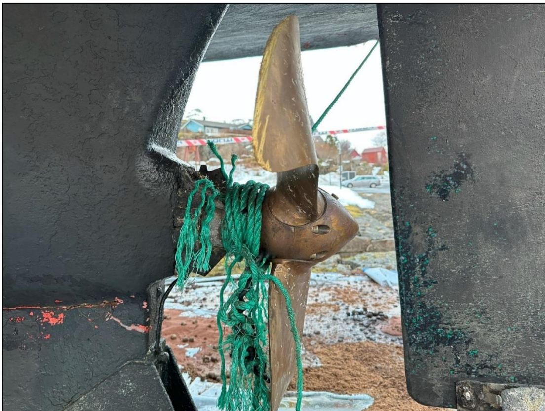
Figur 6: Iletau og skjøteledning i propellen: Foto: SHK
